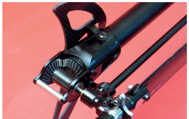
Der gesamte Heckrotor ist hochwertig konstruiert, spielfrei und leichtgängig. Die Blatthalter haben gefräste PMGs (Propellermomentgewichte).
