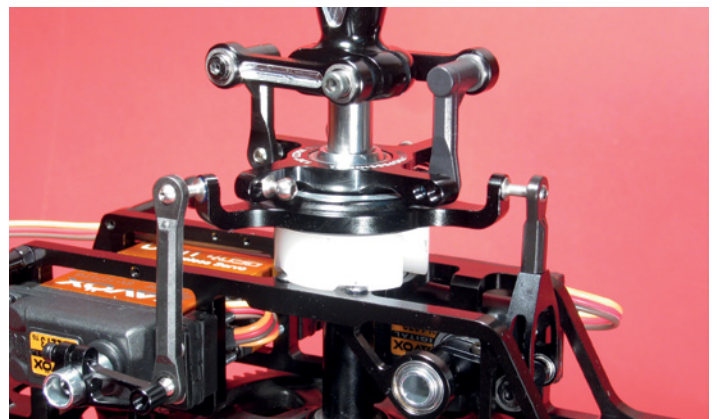
Die Taumelscheiben-Lehre aus eigenem Bestand erleichtert die Grundeinstellung sehr.
