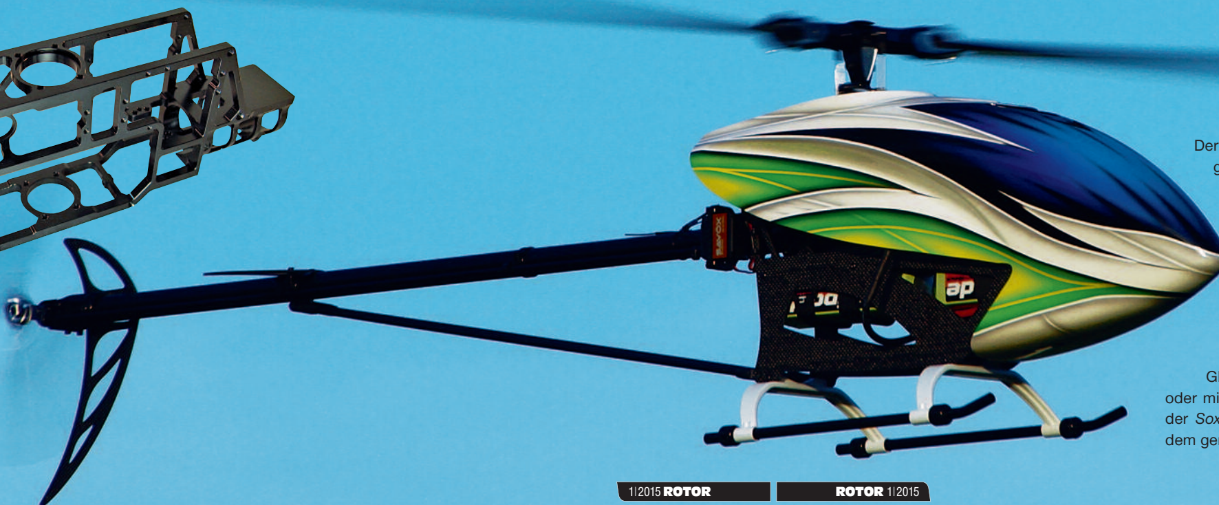
Das einteilige, obere Chassis wird aus dem Vollen gefräst; das Resultat ist ein filigranes Gerüst. Die hierfür nötige Bearbeitung ist mit nicht unerheblichem Aufwand verbunden.
