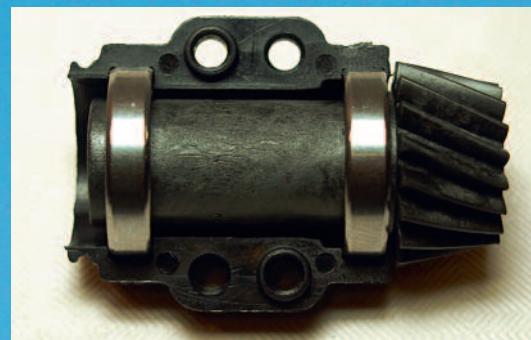
Die Heckabtriebseinheit ist mittels mehrerer Stifte in sich selbst sowie im Hauptchassis fix positioniert. Gerade einmal drei Kunststoffteile sowie zwei Kugellager umfasst (neben der Verschraubung) der Heckabtrieb.
